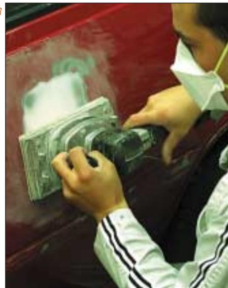
El grado óptimo de grosor de lijado viene determinado por el tipo de pintura que se vaya a aplicar, en general, el factor fundamental es el espesor de pintura que se aplique, cuanto menor sea el espesor de pintura, más fino debe ser el lijado. Así por ejemplo, en el lijado de aparejos para
