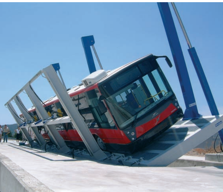
Ensayo de estabilidad.
