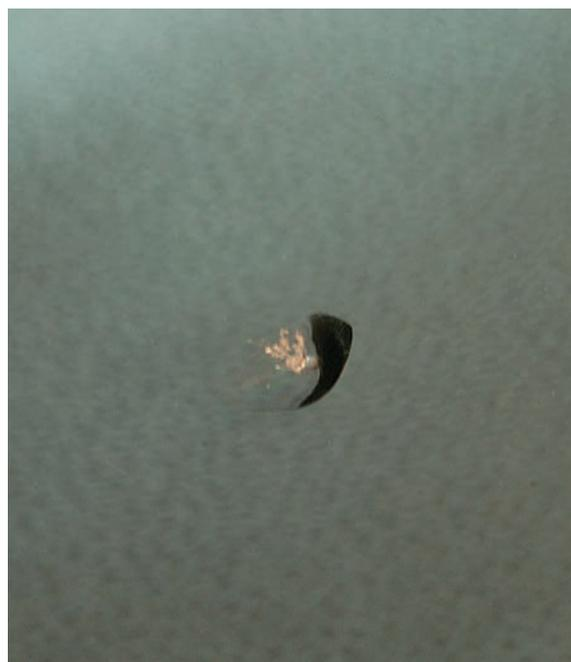
*Cuando el daño en una luna laminada es reparable, debe considerarse la reparación y las ventajas que aporta frente a la sustitución.*
