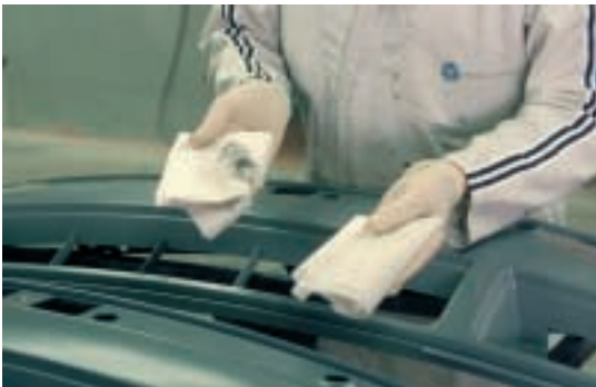
LA IMPRIMACIÓN DEBE RESISTIR LA ACCIÓN DE LOS DESENGRASANTES Y LIMPIADORES
