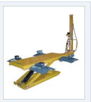
Esta minibancada esta equipada con dos peldaños que facilitan la entrada y salida del vehículo, además de mordazas y tacos de goma. La torre de estiraje tiene un ángulo de rotación muy amplio y viene equipada con un kit de tiro.
